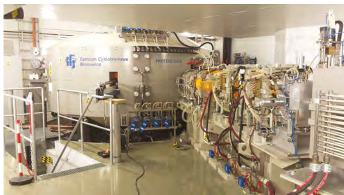
Cyklotron Proteus-235 w Centrum Cyklotronowym Bronowice, przyspieszający protony do energii 230 MeV.
